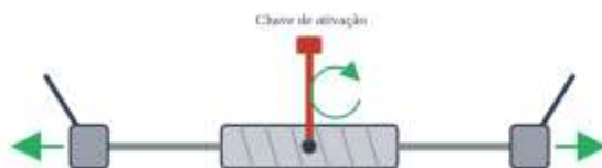
Figura 1 – Mecanismo geral do parafuso expansor: a rotação do corpo central afasta os corpos metálicos ao longo das hastes-guia.
