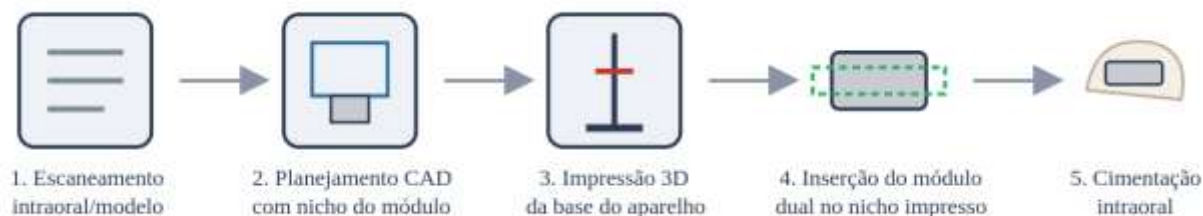
Figura 4 – Fluxo digital de confecção do aparelho com o Módulo Individual Dual de Expansão.
